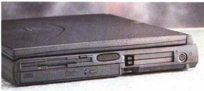
Sul lato sinistro spicca la ventola, per fortuna silenziosissima e quasi sempre ferma. A destra di questa ci sono l'alloggiamento per la batteria e il foro dell'antifurto, alla sinistra il tasto di accensione (a scorrimento), la porta infrarossa, la seriale USB e la porta S-video (standard) per collegare un TVcolor.
